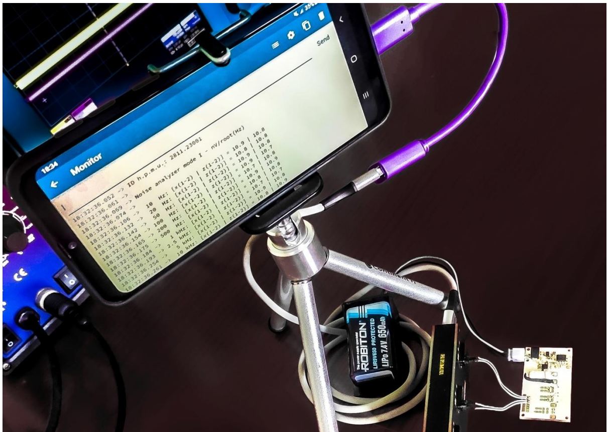
Результат измерения шумовых характеристик двух широкодиапазонных оптических детекторов (без использования каскадов усиления), уровень которых ниже собственных шумов модуля. Отображение данных в Arduino Studio.
