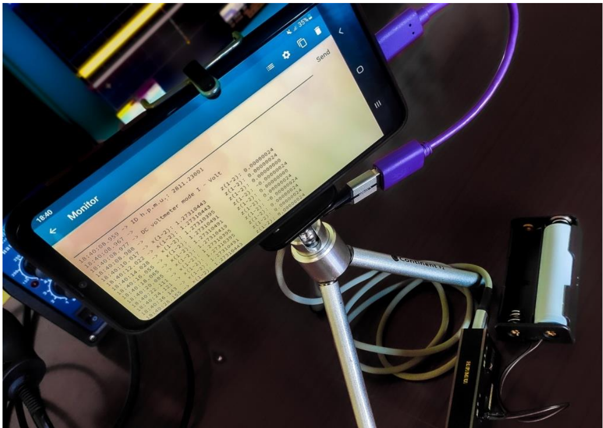
Пример регистрации напряжения (разряженного) аккумулятора 18650 (x-канал) и собственных шумов СИМ на закороченном входе модуля (z-канал) в режиме измерения постоянного напряжения. Отображение данных в Arduino Studio.
